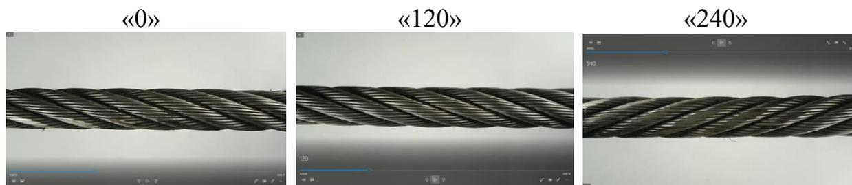
2.5.5. Фрагмент видеопотока конкретного дефекта «3 - местное увеличение или уменьшение диаметра каната» на поверхности стального каната, съемка которого производилась при фиксированном угле поворота «0», «120», «240» относительно оси каната ГОСТ 2688-80, диаметром 16,5 мм
