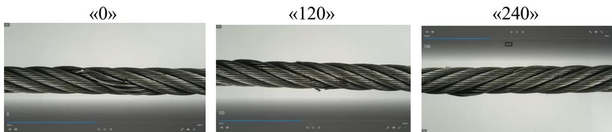
2.5.4. Фрагмент видеопотока конкретного дефекта «2 - наружный износ проволоки» на поверхности стального каната, съемка которого производилась при фиксированном угле поворота «0», «120», «240» относительно оси каната ГОСТ 2688-80, диаметром 16,5 мм
